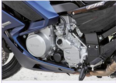
Das Getriebe wurde erst auf die Saison 2016 um einen (lang übersetzten) sechsten Gang erweitert. Zugleich hielt eine Anti-Hopping-**Kupplung Einzug**
